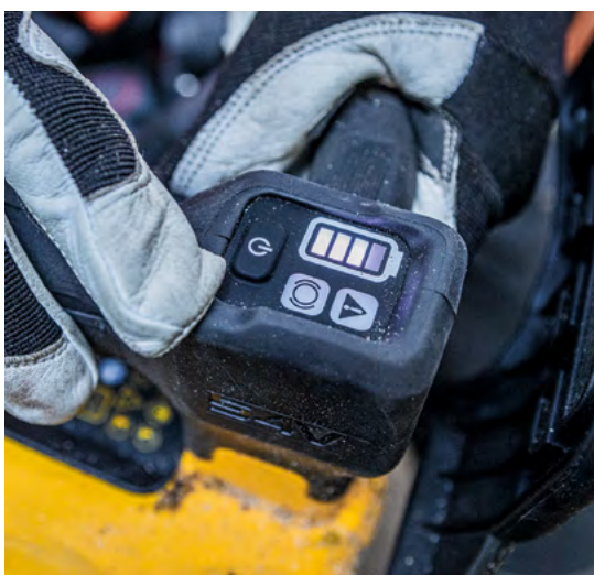
LED displej: Stav nabití – Varování při přetížení – Varování při aktivaci brzdy
